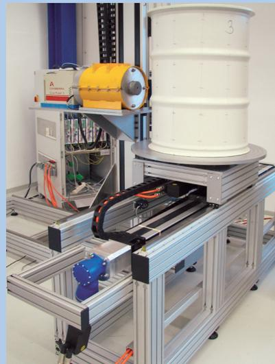
MGS 2: SGS-Messung an einem 200-L-Kalibrierfass
