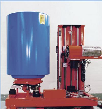
MGS 1: SGS eines 10.000-kg-Gussbehälters
