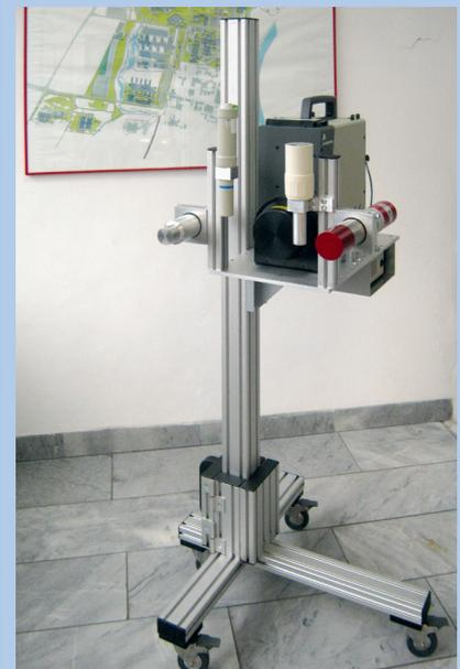
Manuelle Positioniereinheit bestückt mit verschiedensten Detektor-Systemen
