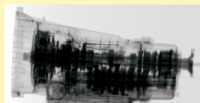
Digitale Radiographie eines PKW-Automatikgetriebes
