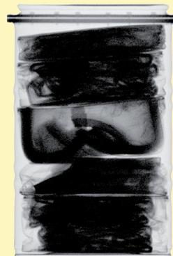
Digitale Radiographie eines 200-L-Fasses mit Pellets
