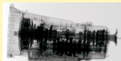
Digitale Radiographie eines PKW-Automatikgetriebes
