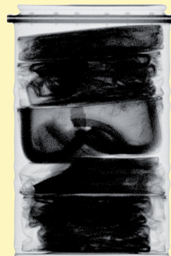
Digitale Radiographie eines 200-L-Fasses mit Pellets
