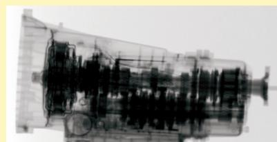
Digitale Radiographie eines PKW-Automatikgetriebes
