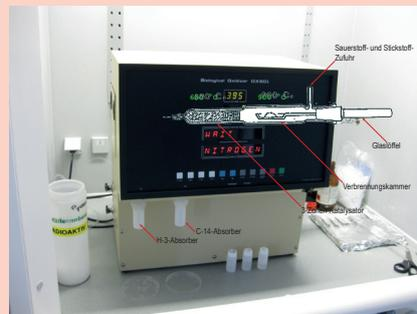
Oxidizer OX-501  $^3\text{H}$  und  $^{14}\text{C}$  in org. Proben
