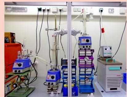
Apparatur zum Freisetzen von  $^3\text{H}$  und  $^{14}\text{C}$  durch Ansäuern und destillieren
