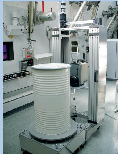
Dreheinheit und Hubeinheit mit elektrogekühltem batteriebetriebenen HPGe-Detektor bei IGS-Messung einer Press-trommel
