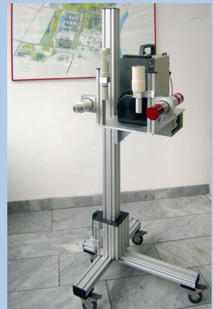
Manuelle Positioniereinheit bestückt mit verschiedensten Detektor-Systemen
